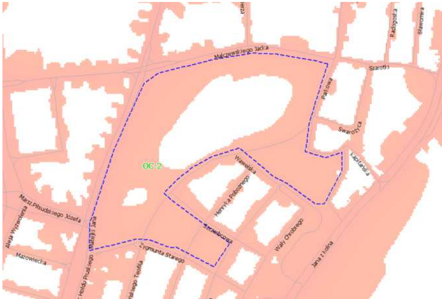
Rysunek 2.6-3 Zasięg występowania hałasu określonego wskaźnikiem L_{DWN} większego od 55dB(A) na terenie parku Żeromskiego
