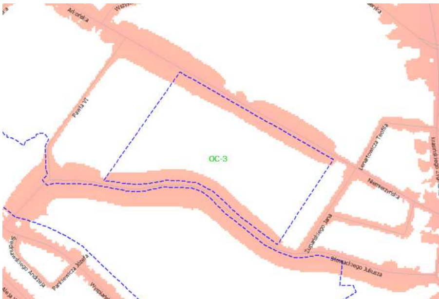
Rysunek 2.6-4 Zasięg występowania hałasu określonego wskaźnikiem L_{DWN} większego od 55dB(A) na terenie ogrodu dendrologicznego.
